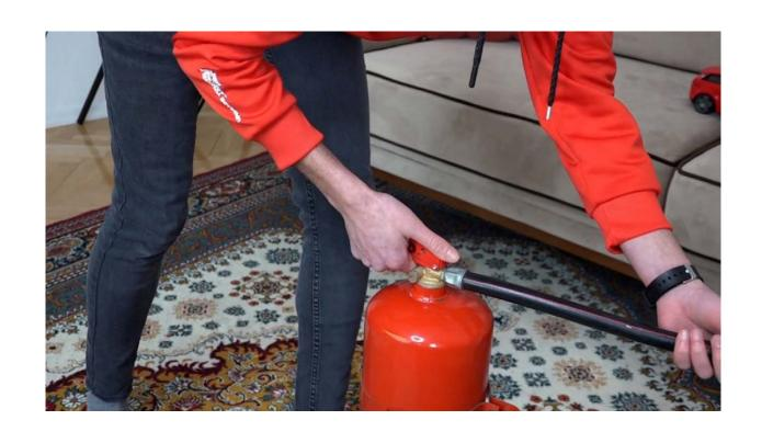
PRIMA DI AVVICINARMI AL FUOCO, DEVO PREMERE LA VALVOLA DI EROGAZIONE E MANTENERE IL TUBO IN DIREZIONE ORIZZONTALE.
